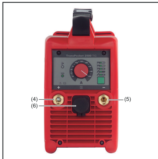
Elementos e conexões nos lados dianteiro e traseiro
