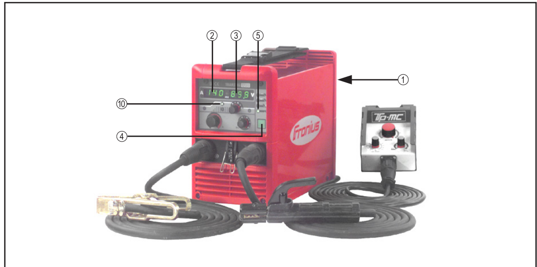
Abb. 21 Transtig 1600 / 1700 als E-Handsweißgerät bestehend aus: Stromquelle mit Steuereinheit, Handfernregler TPmc (wahlweise) und Schweißkabeln
