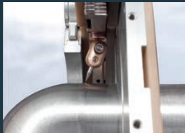
Schwenkbarer Elektrodenhalter für Rohr - Rohrbogen Anwendungen
