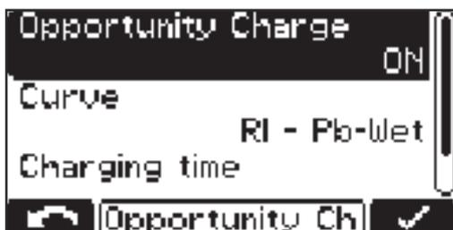
Afin d'augmenter la durée de l'intervalle de fonctionnement de la batterie, il est par exemple possible de la recharger lors d'un arrêt de fonctionnement.
